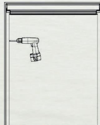
Fissare, con le viti e i tasselli in dotazione, le guide nel vano.
